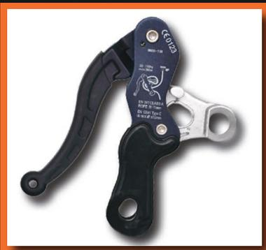
> Equipo diseñado para descenso con freno automático para cuerdas con un diámetro desde 10mm hasta 12mm el cual permite el controlado y el posicionamiento a lo largo de una cuerda para labores en alturas reduciendo significativamente el riesgo de caída por error humano.
