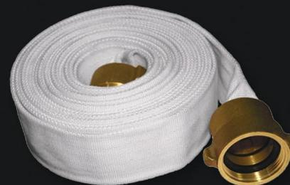
> 100% poliéster, forro de caucho sintético, coples de aluminio, 800psi de presión de prueba, 400psi de presión de servicio.
